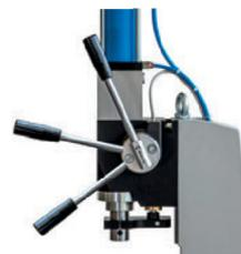
Il peut être positionné en 4 points sur 180° pour un plus grand confort de travail. Pour modifier la position du levier, dévissez-le et revissez-le à l'emplacement souhaité.
