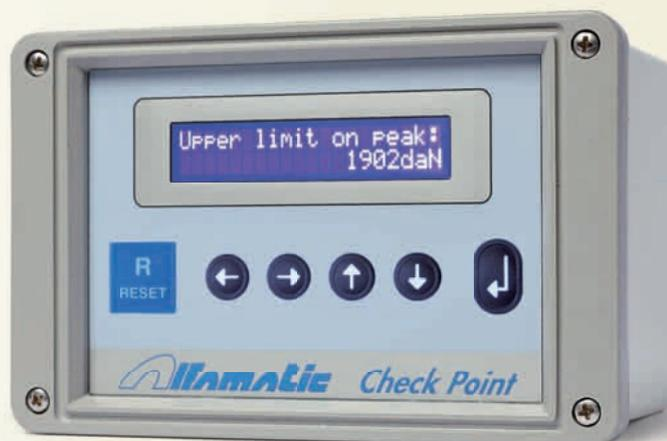
Collegato a un solo trasduttore ne visualizza il valore in tempo reale.
